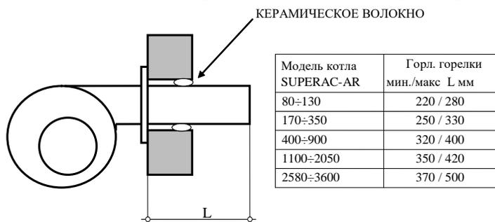
Установите горелку на монтажной плите таким образом, чтобы пламенная голова горелки была параллельно стенкам топки и находилась строго по центру: в ином случае могут возникнуть отклонения от нормального процесса горения, и серьезное повреждение котла
